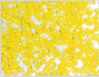
従来機 (φ6mm斜穴スクリーン) Conventional (φ6mm inclined-hole screen)
