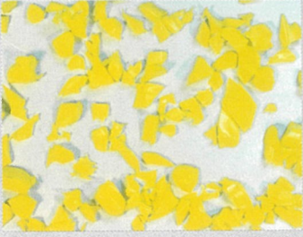
PS-360 (φ6mm 斜穴スクリーン) PS-360 (φ6mm inclined-hole screen)
