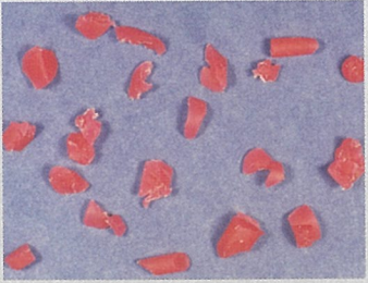
P-1328 (φ6mm 斜穴スクリーン) P-1328 (φ6mm inclined-hole screen)
