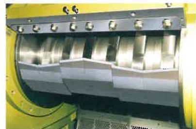
波形配列のヘルカルエースカッタ Helical "Ace cutter" of wave form arrangement
